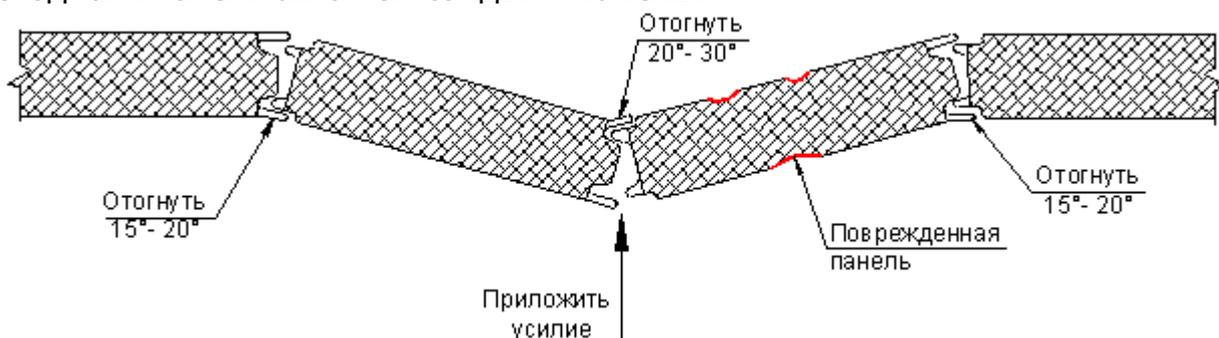
Д опускается смежную сэндвич-панель не удалять, а отвести ее из плоскости стены на 200 мм со стороны удаленной сэндвич-панели и закрепить ее соответствующим образом временными приспособлениями.
