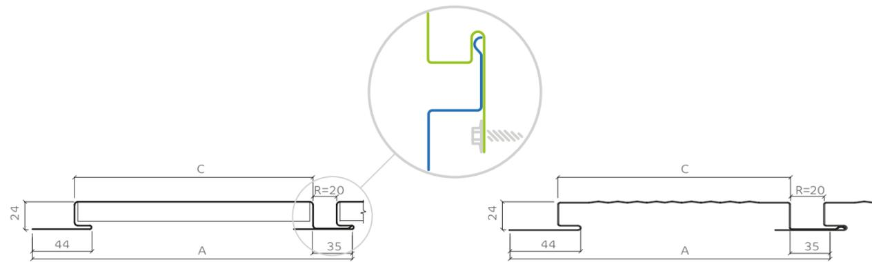
C – рабочая ширина. А – габаритная ширина (мм). R – руст (мм).
