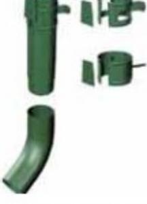
Держатели крепятся к несущей стене из расчета 1:1 (один держатель на каждый метр водосточной трубы и на стыке 2-х труб). Сама труба отрезается до заданной длины, вставляется в держатель и фиксируется замковым соединением.
