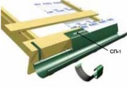
Желоба соединяются между собой встык с зазором в 2-3 мм, затем фиксируются в держателях. Только после этого к обрешетке крепятся карнизные планки. На месте стыков желобов устанавливаются соединительные элементы с резиновыми прокладками. Задний фланец соединителя зацепите за внутреннюю кромку желоба, передний край подтяните к желобу и защелкните замок.
