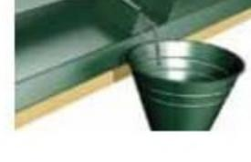
Для фальцевой крыши и кровель сложной конфигурации вместо желобов применяются водосборные воронки. Вставьте нижнюю часть воронки в верхнее колено водосточной трубы и закрепите конструкцию саморезами на карнизе.
