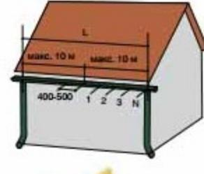
Отмечаем на нижней части обрешетки места установки держателей. Расстояние между ними не должно превышать 10 м (т.е. не более 10 метров желоба на одну водосточную трубу). Желоб можно отпилить до требуемой длины. Рекомендуемое расстояние между держателями – 40-50 см, угол уклона желоба – до 5 мм на каждый метр длины. Если уклон будет меньше, желоб переполнится водой, при большем уклоне воронки не справятся с потоками воды.
