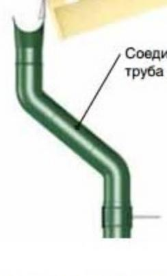
Выпускные воронки необходимо подсоединить к водосточной трубе. Для этого потребуется два колена и одна соединительная труба. Ее длина уточняется при монтаже, труба отпиливается до требуемого размера.
